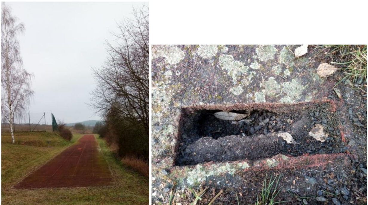
Foto 6: Probenahmestelle roter Kunststoffoberbelag (2 cm stark, Probe EP3) Sprinterbahn mit Unterbau aus feinem Schotter / Splitt (Probe EP4)
