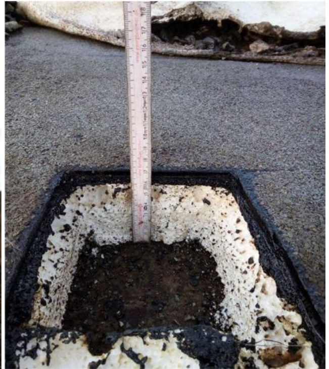
Foto 13: Dachaufbau Hausmeisterwohnhaus, Styropor HBCD-haltig (Probe MP2)
